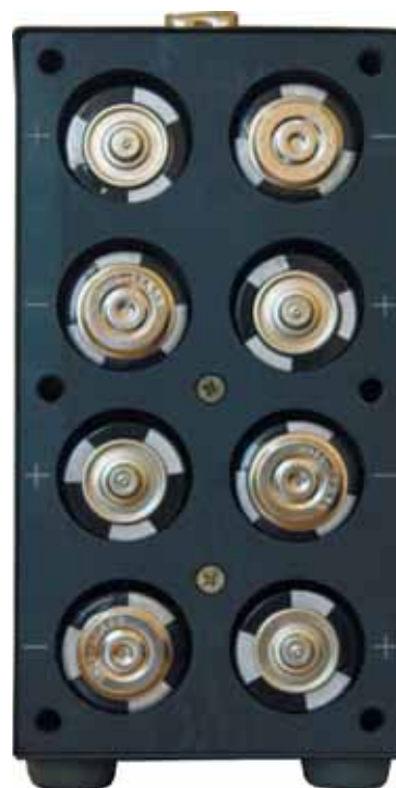
На фото: Батарейный отсек БНП-1 со снятой крышкой.
