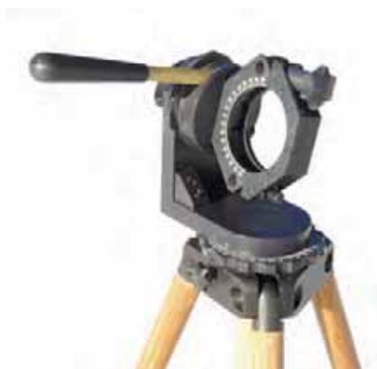
На фото: Узел крепления штатива ШАД-01.
