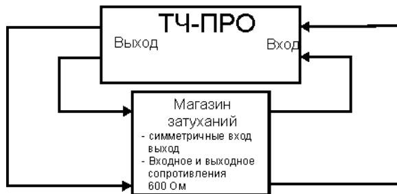
Рисунок 8.4. Проверка измерителя уровня с использованием магазина затухания.
