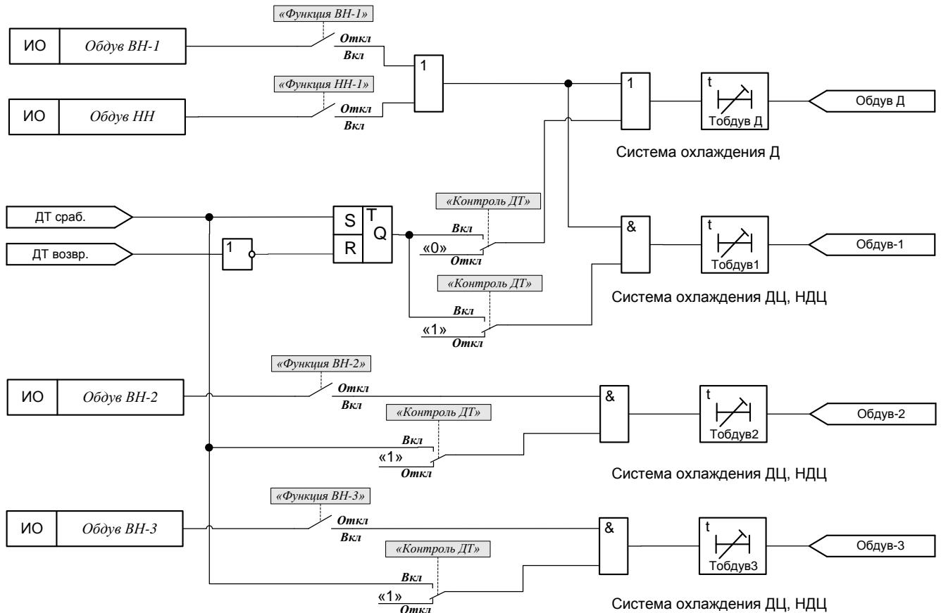
Рисунок 10 – Функционально-логическая схема блока автоматики управления системы охлаждения силового трансформатора вида «Д», «ДЦ» и «НДЦ»
