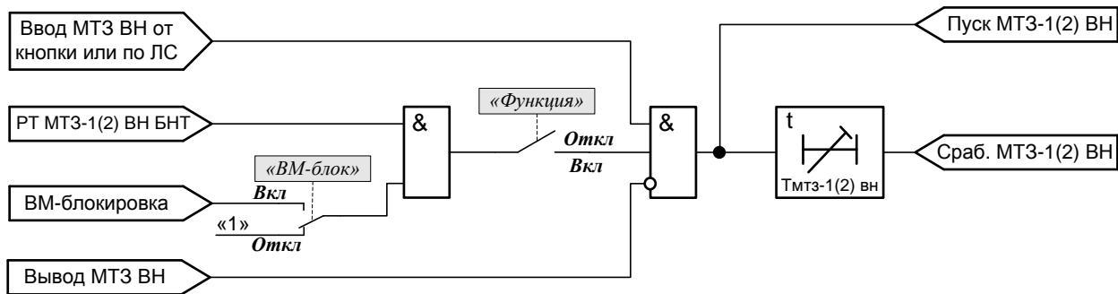
Рисунок 5 – Функционально-логическая схема блока МТЗ-1(2) ВН
