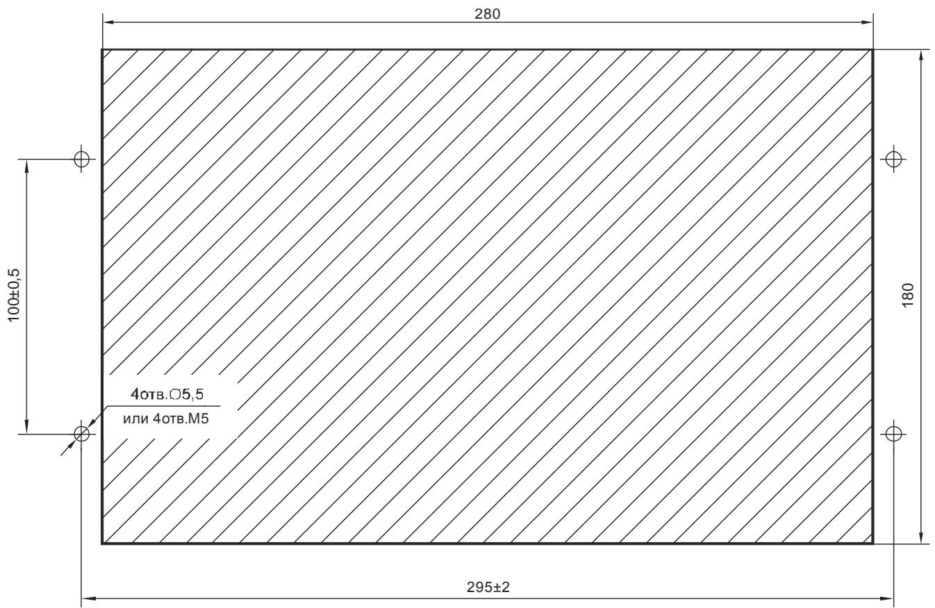
Рисунок Е.5 – Разметка панели под установку устройства
