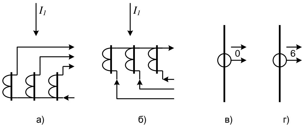
Рисунок 2 – Соединение ТТ в нулевую и в шестую группы (а, б)
