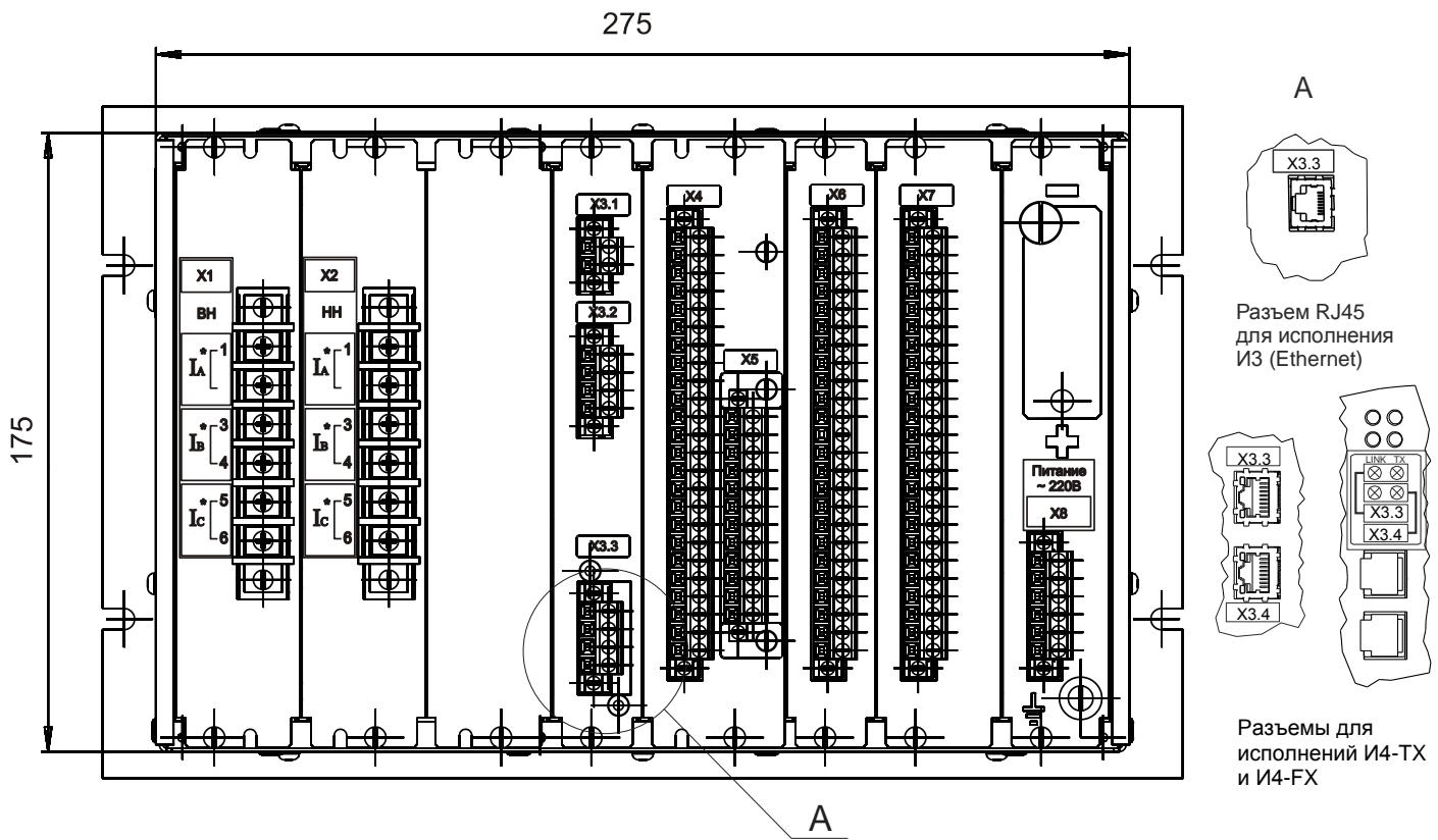
Рисунок Е.4 – Расположение элементов на задней панели устройства «Сириус-Т»
