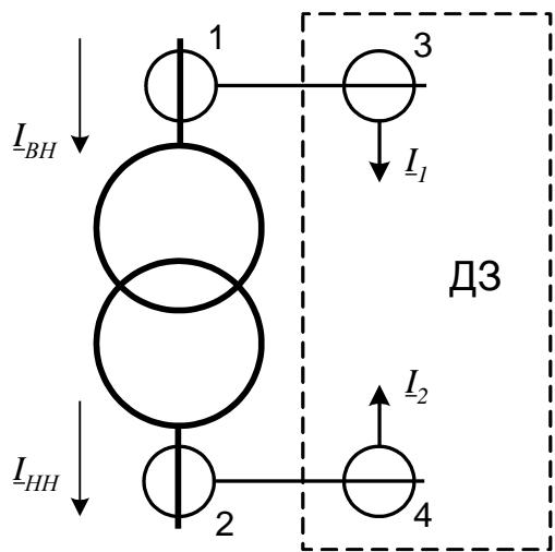
Рисунок 1 – Принятые положительные направления токов в трансформаторе:
