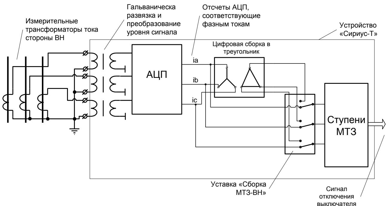
Рисунок 6 – Схема реализации ступеней МТЗ ВН
