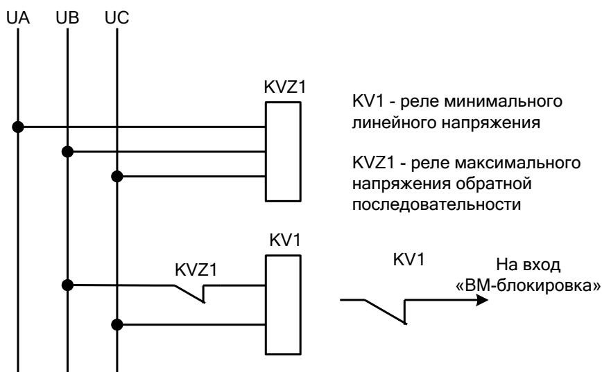
Рисунок 7 – Пусковой орган напряжения
