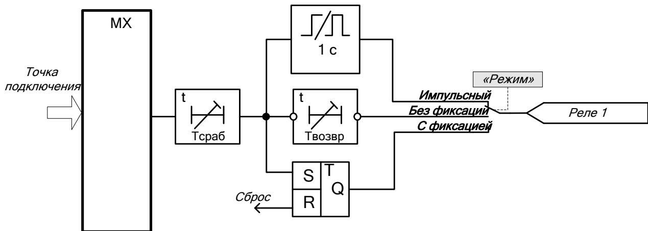
Рисунок 12 – Фрагмент функциональной логической схемы
