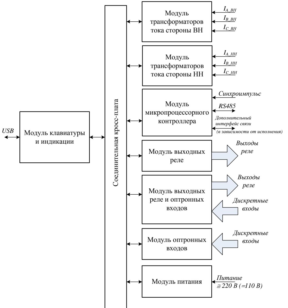
Рисунок 13 – Структурная схема устройства «Сириус-Т»
