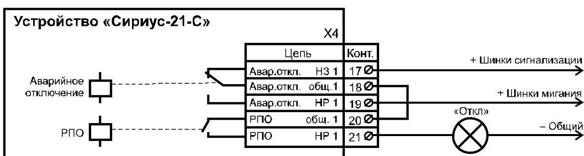
Рисунок Д.4 – Вариант реализации схемы с миганием сигнальной лампочки аварийного отключения устройства с использованием общеподстанционной схемы сигнализации
