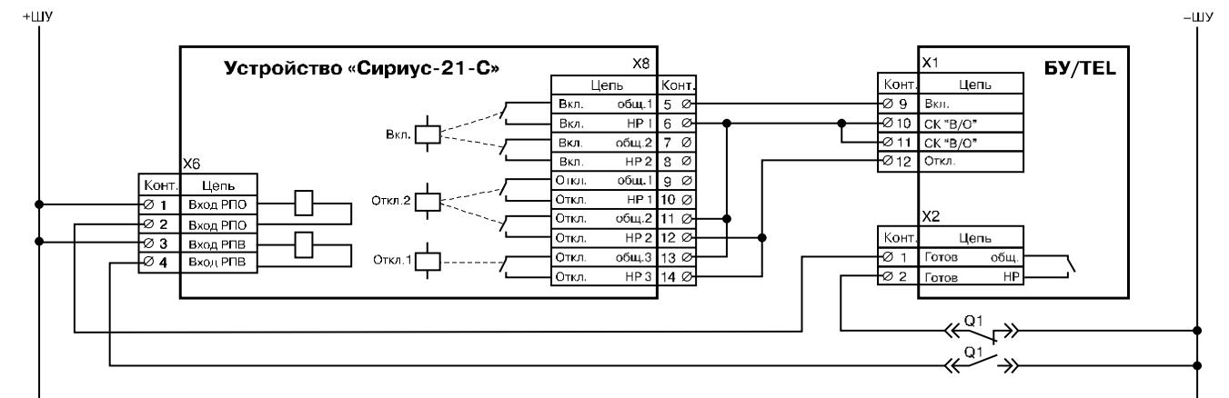
Рисунок Д.3 – Схема подключения устройства «Сириус-21-С»
