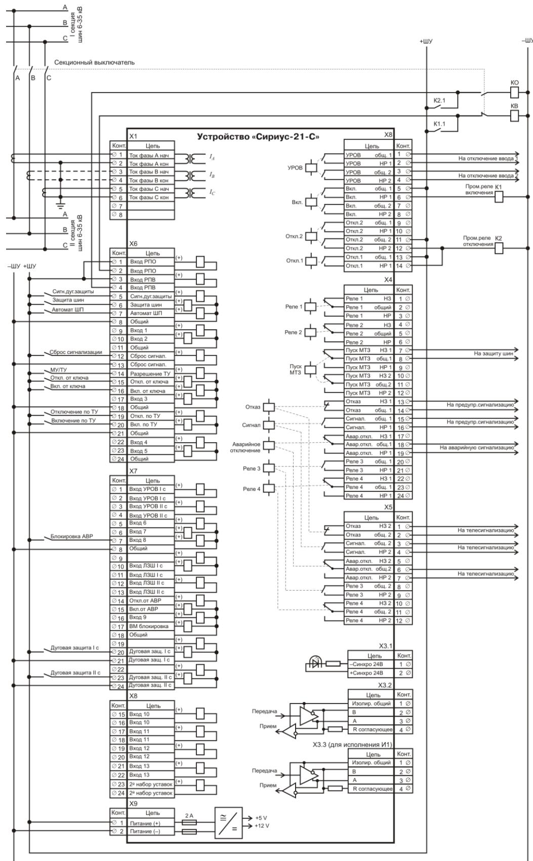
Рисунок Д.2 – Схема подключения внешних цепей к устройству «Сириус-21-С»
