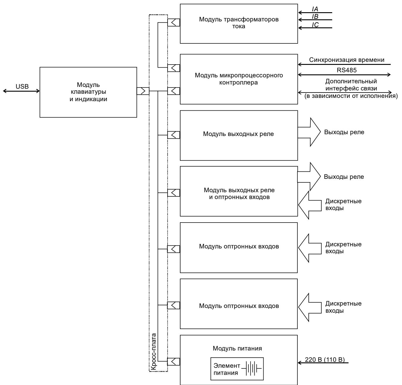
Рисунок 1 – Структурная схема устройства
