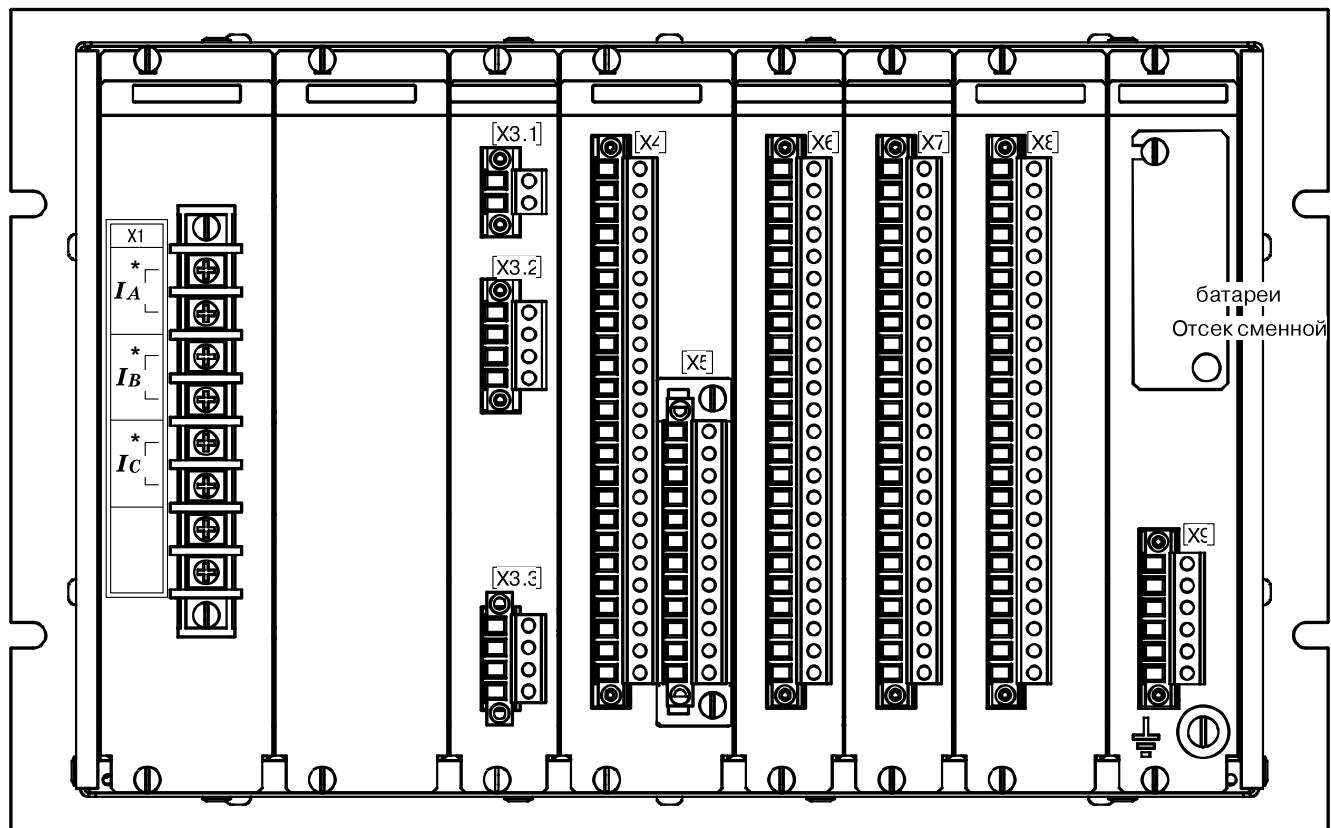
Рисунок Г.6 – Расположение элементов на задней панели устройства «Сириус-21-С»
