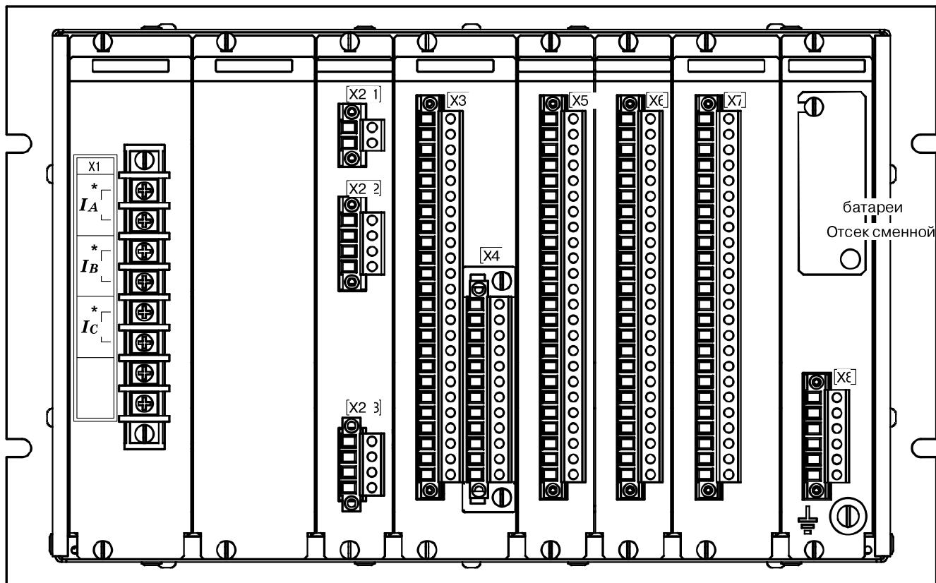
Рисунок Г.5 – Расположение элементов на задней панели устройства «Сириус-2-С»
