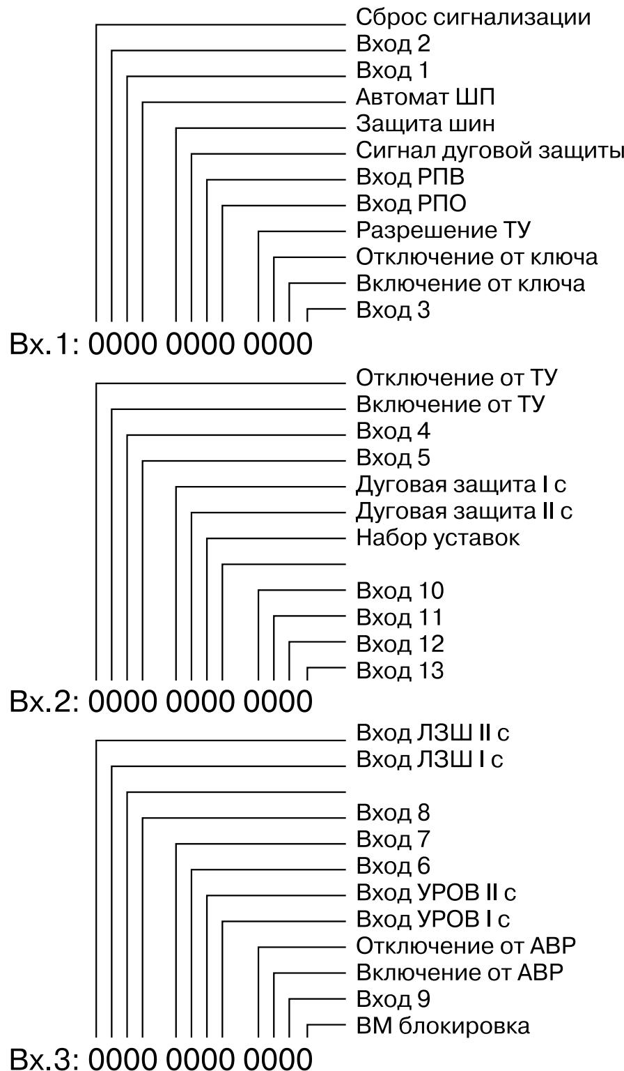
Рисунок В.1 – Соответствие входных дискретных сигналов в режиме «Контроль входов». Наличию сигнала на входе соответствует «1», отсутствию – «0».
