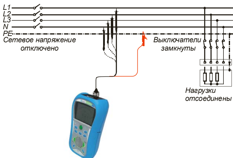
Рисунок 5.2: Подключение 2-проводного измерительного кабеля
