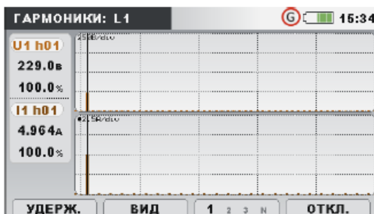
Рисунок 3.31: Экран гистограмм гармоник
