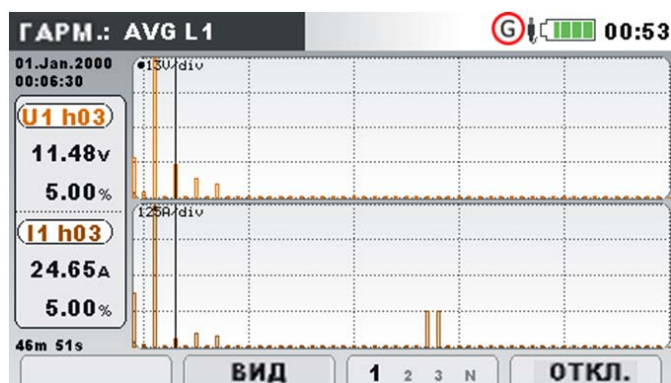
Рисунок 3.32: Экран гистограмм средних значений гармоник
