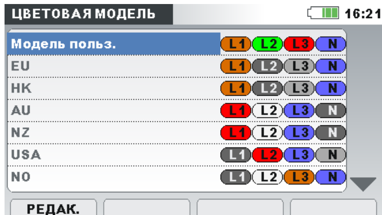
Рисунок 3.74: Цветовое представление фазных напряжений
