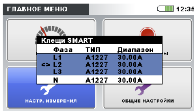
Рисунок 4.19: Состояние автоматически распознаваемых токовых клещей
