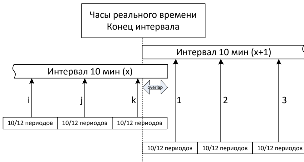
Рисунок 5.14: Синхронизация и объединение интервалов продолжительностью 10/12 периодов
