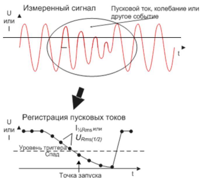
Рисунок 5.22: Триггерные сигналы по уровню
