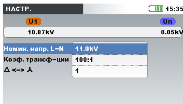
Рисунок 4.13: Коэффициент трансформации для трансформатора 11 кВ/110 кВ (пример)
