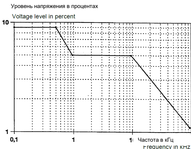
Рисунок 5.24: Предельные уровни сигнальных напряжений, передаваемых по электрическим сетям, согласно стандарту EN50160
