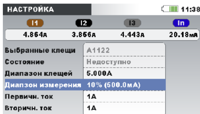
Рисунок 4.17: Выбор 10-процентного диапазона для токовых клещей
