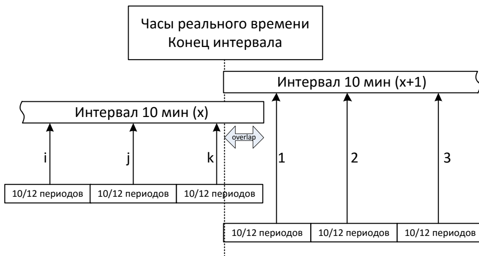
Рисунок 5.14: Синхронизация и объединение интервалов продолжительностью 10/12 периодов
