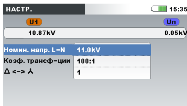
Рисунок 4.13: Коэффициент трансформации трансформатора 11 кВ/110 кВ (для примера)
