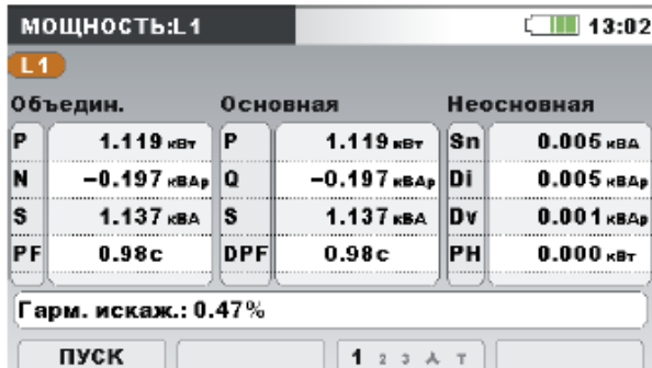
Рисунок 3.24: Подробные данные измерения мощности в фазе L1
