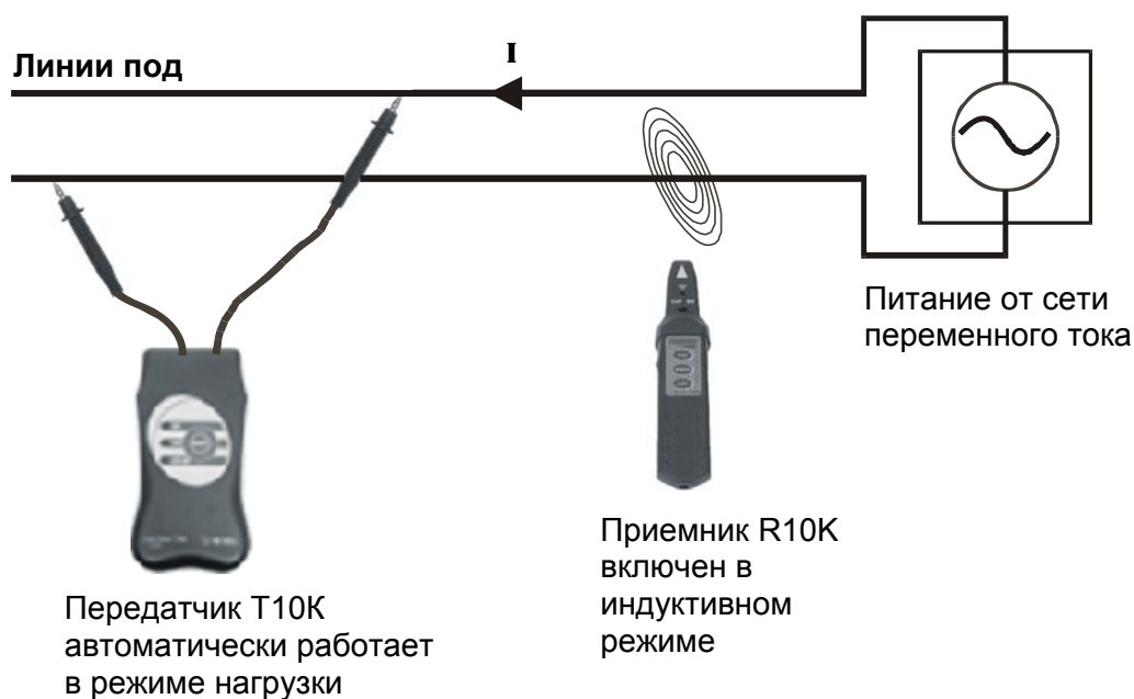
Рис. 3 Передатчик работает как активная нагрузка
