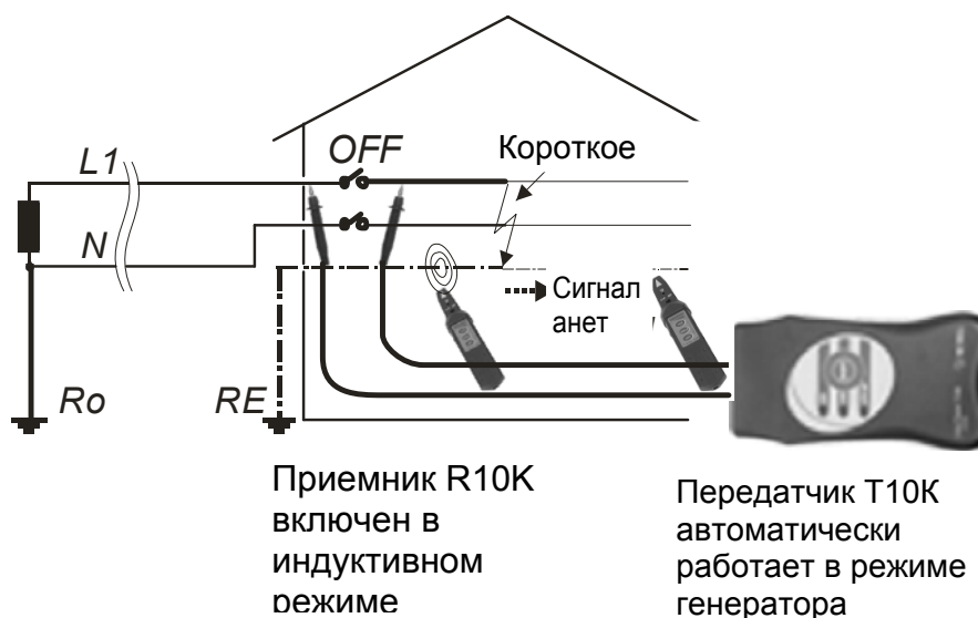
Рис. 15 Определение местоположения короткого замыкания
