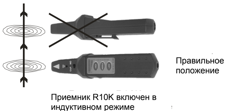
Рис. 4 Обнаружение электромагнитного поля
