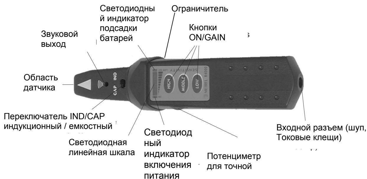
Рис. 2 Приемное устройство R10K
