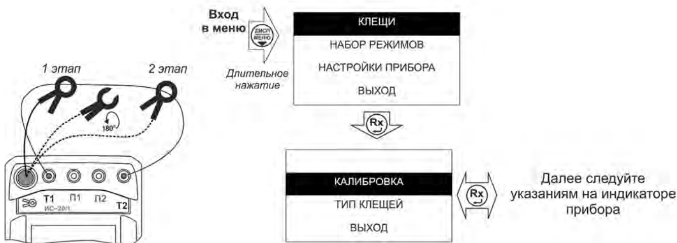
Рисунок 2.14 – Калибровка токоизмерительных клещей
