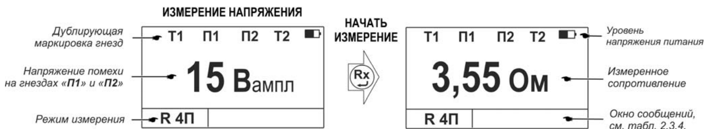
Рисунок 2.4 – Схема подключения и вид индикатора при измерении сопротивления заземления четырёхпроводным методом
