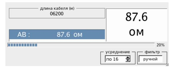
Шлейф измеряется только между проводами А и В. Если выбрана марка кабеля, то результат измерения пересчитывается в длину кабеля.
