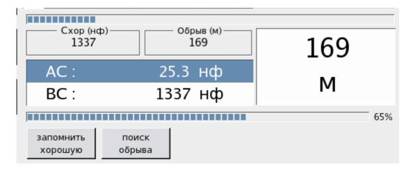
2. Поиску обрыва. Выбрав хорошую и оборванную жилу, подключите их к прибору в любом порядке к разъемам А и В. Провод С подключите к оболочке кабеля (земле). Измерьте емкость жил. Выберите жилу, с которой надо сравнить оборванную, и нажмите [запомнить хорошую]. После этого нажмите [поиск обрыва]. Прибор покажет расстояние до обрыва в метрах (если длины введена) или процентах длины кабеля.
