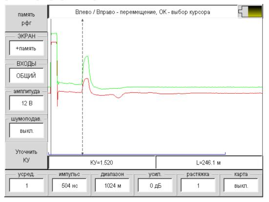
На экране рефлектометра два курсора, между которыми измеряется расстояние на рефлектограмме. Кнопка [OK] делает активным то один, то другой курсор. Смещение активного курсора кнопками ◀►. Вертикальное смещение рефлектограммы – кнопки ▲ ▼.
