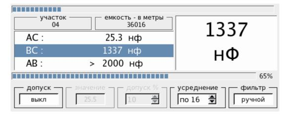
Результат измерения емкости пересчитывается в расстояние для всех кабелей из Списка, кроме Кабеля 100%. Верхняя строка-индикатор показывает это расстояние.
