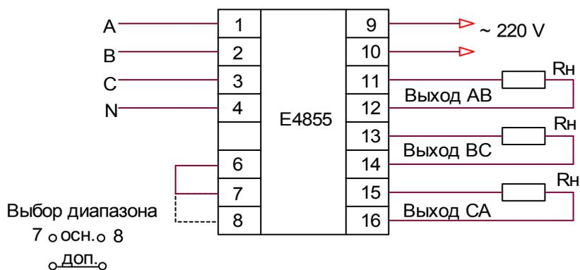
Рисунок В.2 Режим измерения междуфазных
