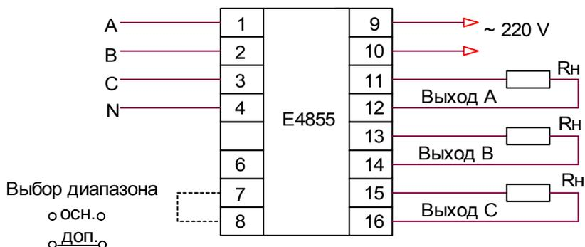
Рисунок В.1 Режим измерения фазных напряжений
