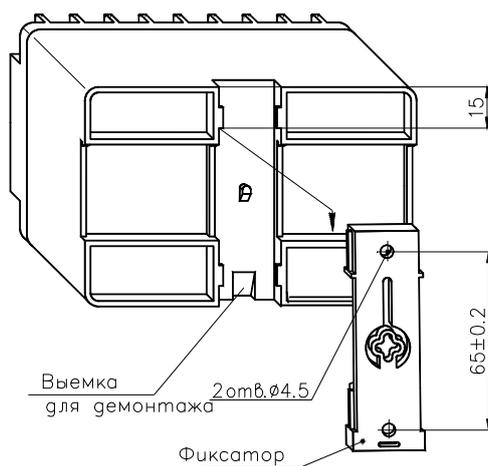
Рисунок Б.2 Вариант крепления на панель
