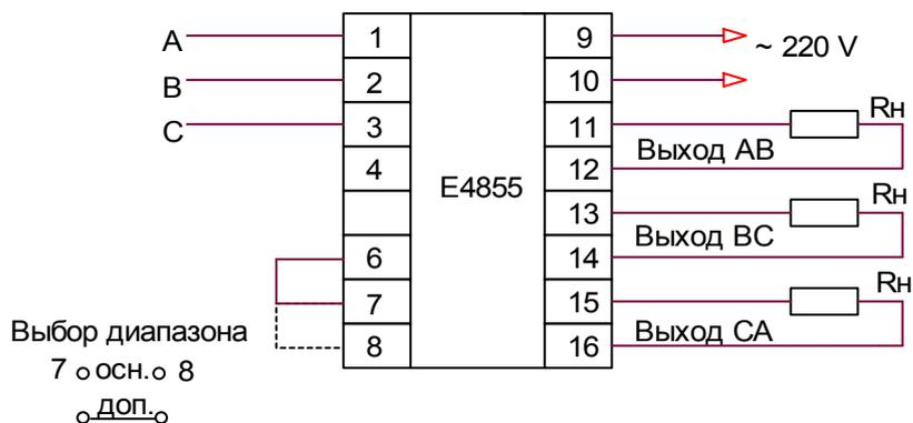
Рисунок В.3 Режим измерения междуфазных
