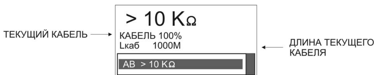
Рисунок 12-3. Экран прибора в режиме измерения сопротивления шлейфа
