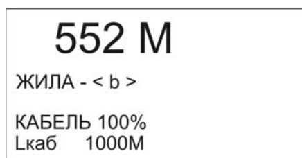
Рисунок 12-5. Экран измерения расстояния до повреждения изоляции
