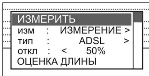
Рисунок 9-25. Меню параметров измерения скоростного потенциала линии.
