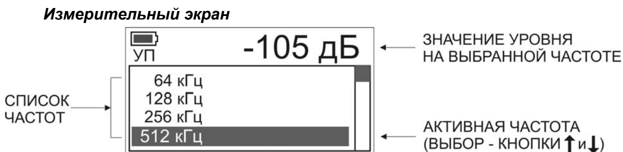
Рисунок 9-13. Экран режима узкополосного измерения уровня
