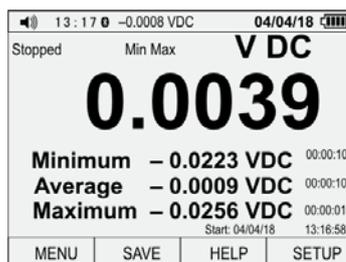
Если измеренный сигнал преодолет нижнюю границу прежнего минимального значения или верхнюю границу прежнего максимального значения, то показания подвергнутся обновлению до значения данного сигнала. Измеритель также записывает дату, час и время, в которое зарегистрировано вышеуказанное значение.
