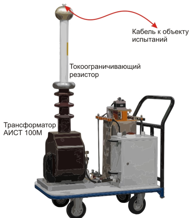
Рис. 4. Подключение токоограничивающего резистора
