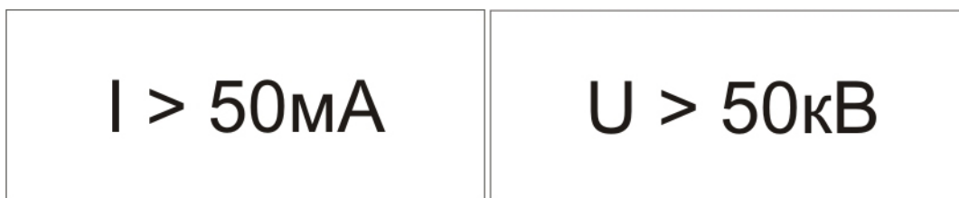
Рис. 14. Выход за установленный диапазон по току / напряжению
